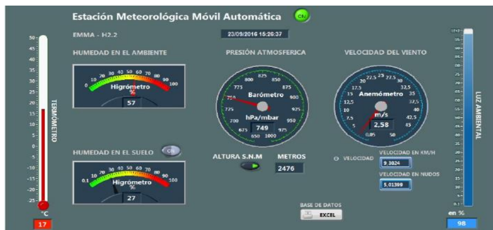
Figura 1.10 Interfaz gráfica de la estación meteorológica móvil e inalámbrica
