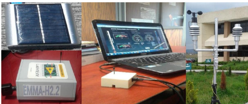
Figura 1.11 Sistema de monitoreo de las variables físicas
